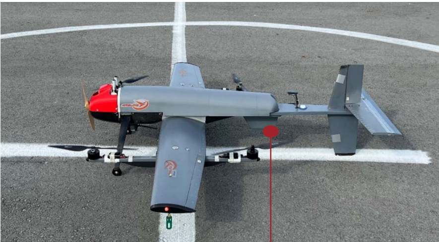
БпЛА «Пчелка» с антенной ретранслятора
