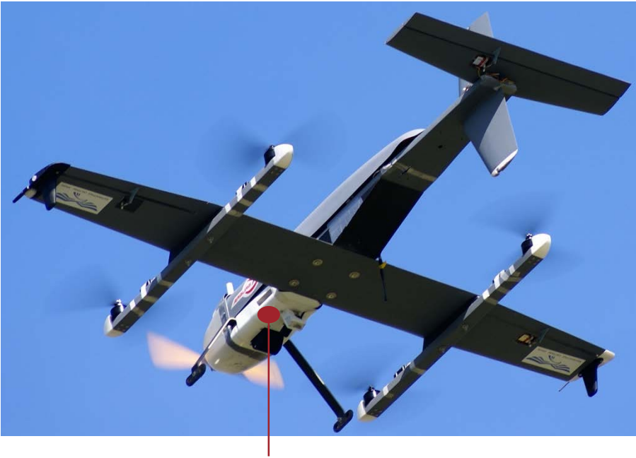
БпЛА «Пчелка» с полезной нагрузкой
