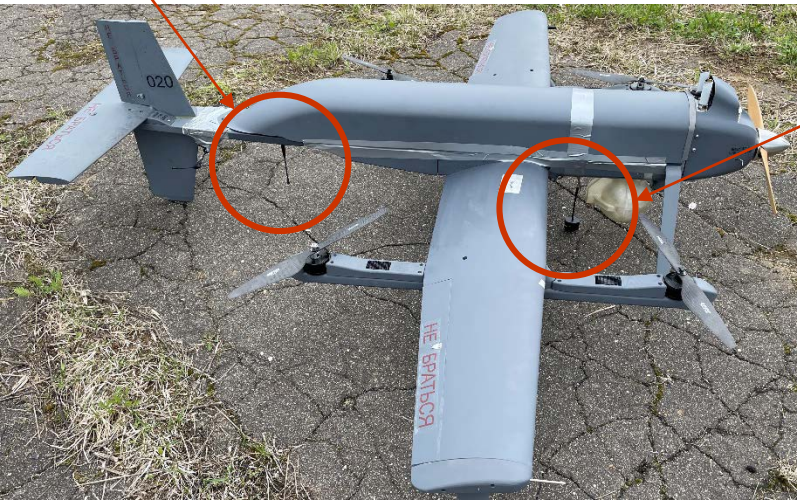
БПЛА «Пчелка» с ретранслятором для frv-дронов
